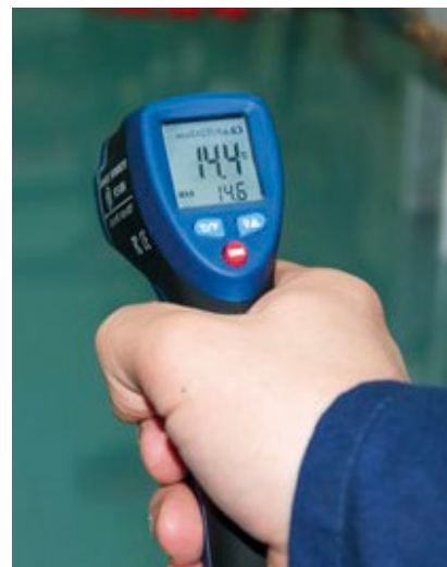
Imagem 4. Termômetro para medição da temperatura do piso
